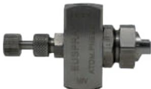
Ha le stesse caratteristiche dell'ugello E1 con la possibilità di chiudere del tutto o parzializzare l'ingresso del liquido, grazie alla presenza di un ago di regolazione posto sulla parte posteriore del corpo.
